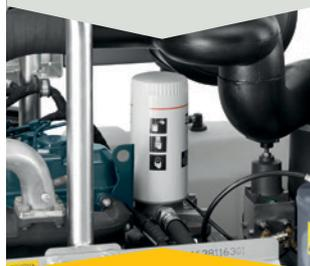
Leicht zugänglicher Kompressorölfilter
